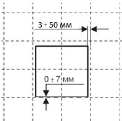
1. Разметьте на стене положение люка относительно плитки и прорежьте проем в размер люка.
